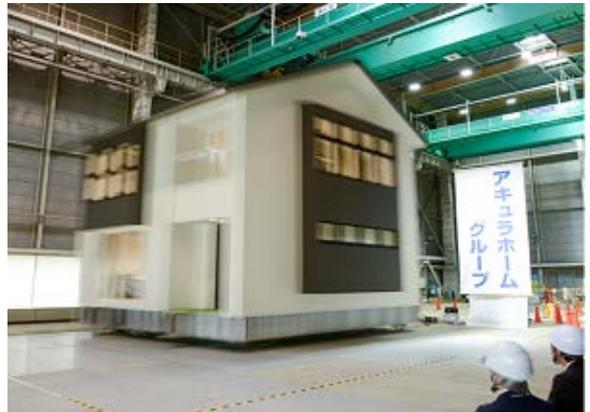
この実験の検証で、10回の大規模地震に被災したにもかかわらず、構造体については実験前の状態に比較して、接合部の緩み、金物の変形、材の破損、内装にも損傷などが全く見られず、地震後も住み続けられる建物であり、自由度の高い注文住宅においても住む人に大きな安心をお届けできることが実証されました。
